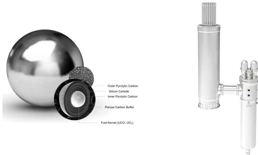
< 그림 II - 3 TRISO-X 핵연료 및 Xe-100 주기기 >
